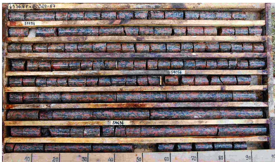
Joonis 3. Kaaliumgraniit (kvarts-montsoniit) Virtsu puuraugu F309 südamikus sügavuselt 536,8–544,0 m
