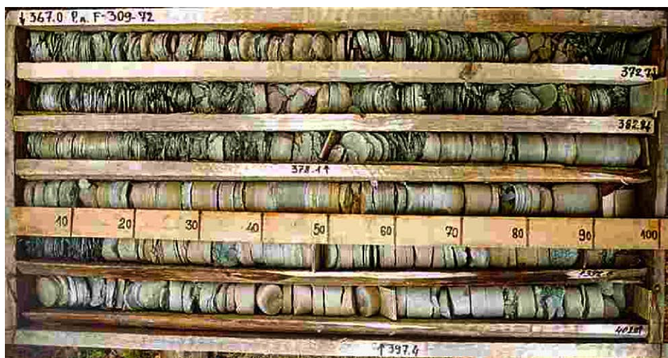
Joonis 4. Voosi kihistu liivakivid ja savikad kiltkivid Virtsu puuraugu F309 südamikus sügavuselt 367–402 m
